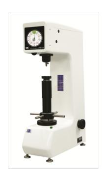
使用洛氏硬度计要注意的问题: 1. 洛氏硬度时试验时试样的安置: 必须保证所施加的作用力垂直于试面。对于弯曲形状及其它不规则形状的试样,必须采用相应类型的专门运作台,并选择正确的试验装置。如对圆柱试样,必须采用"V"型运作台。2. 洛氏硬度计的稳定性: 洛氏硬度计不宜经常调整其测量杠杆,应保持其稳定性。可用一、二套较好的标准硬度块,定期在同一硬度块上试验,以确认仪器的长期稳定性,掌握其性能。在硬度试验前,应用与试样硬度值接近的标准硬度块校机,使得试验结果更为可靠。
