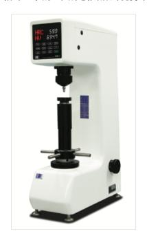
使用洛氏硬度计前的准备工作:洛氏硬度计由于其特性,压力小所以压痕不会明细,特别是表面洛氏硬度试验的压痕更小,对大多数工件的使用无影响。被测试件应稳定地放在试台上,试验过程中试件不得移动,并保证试验力能垂直施加于试件上。被测试件为圆柱形时,必须使用"V"型试台。根据试件的形状、大小选择合适的试台,试件若异形,则可根据具体的几何形状自行制造专门夹具,使硬度测试具有可靠的示值。球压头表面不容许污垢、油脂及氧化物等存在,球压头在硬度测试中不变形,试验后不应有损伤。天津模具洛氏硬度计生产厂家洛氏硬度计使用方法:将工作台置于丝杠台上。
